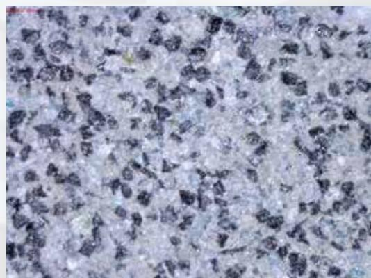
Widok struktury warstwy ściernicy ceramicznej CBN / The view of structure of CBN abrasive layer
